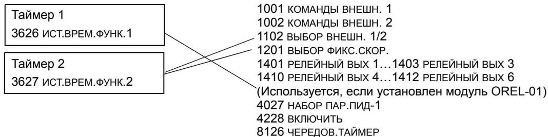
Для упрощения конфигурирования может использоваться мастер установки таймерных функций. Дополнительные сведения см. в разделе [Режим мастеров](#) на стр. 64.
