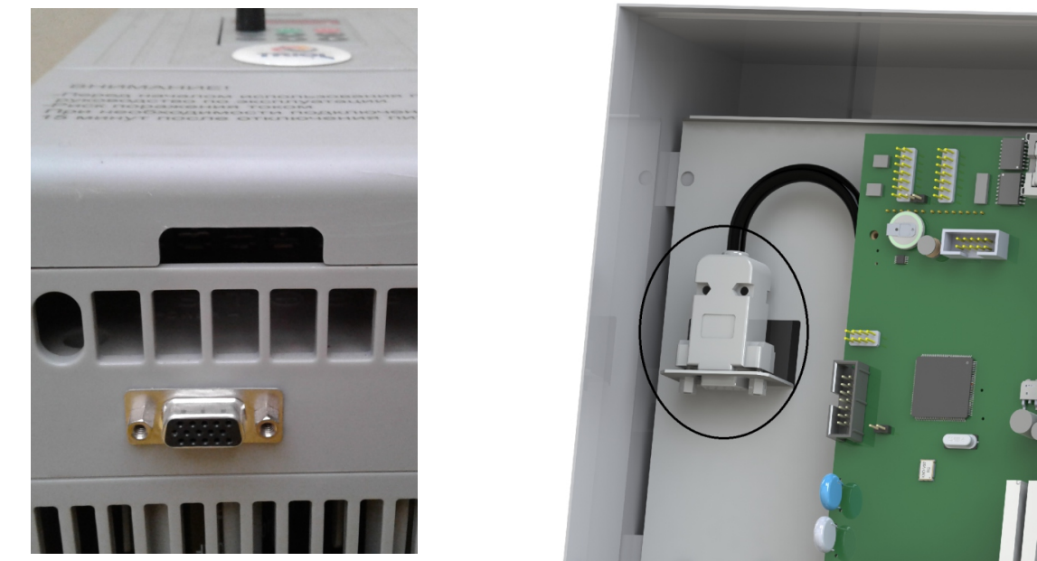
Рисунок 2.24 — Расположение разъёма для подключения энкодера: 5K5...7K5 — слева, 11K...18K — справа
