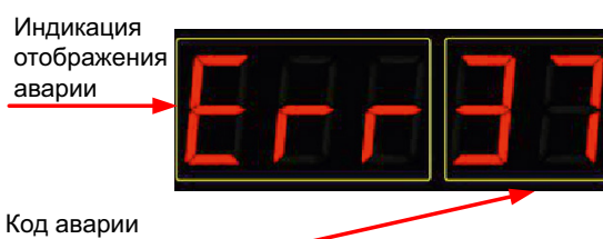
Рисунок 3.4 – Индикация пульта в режиме отображения кода аварии
