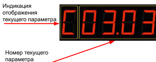
Рисунок 3.5 – Индикация просмотра 16-ти последних измененных параметров
