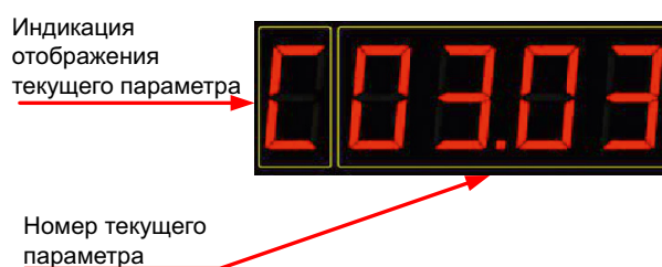
Рисунок 3.6 – Режим отображения/ввода значения параметра
