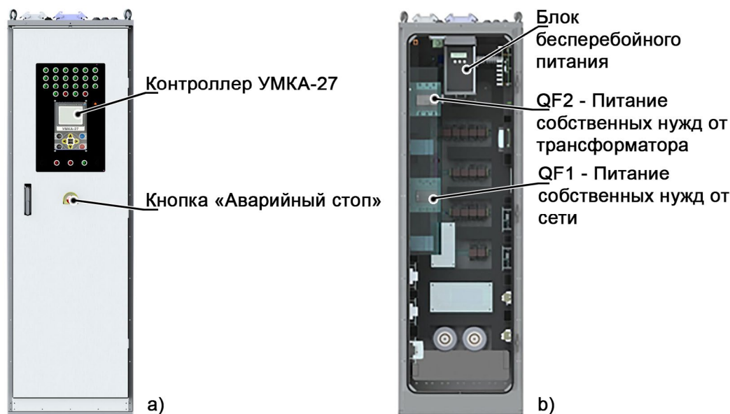
Рисунок 3.5 — Расположение автоматических выключателей в шкафу управления
