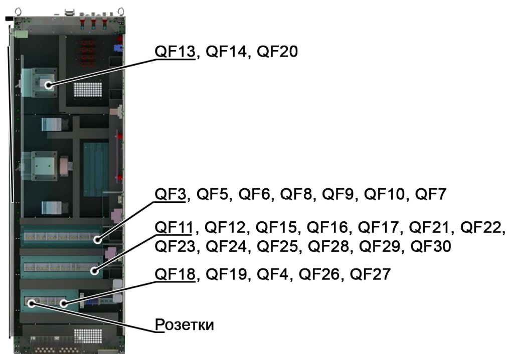
Рисунок 3.4 — Внешний вид шкафа коммутации
