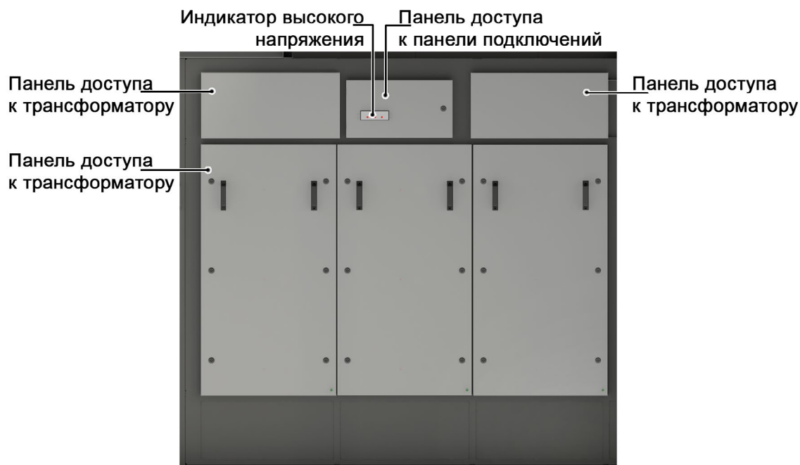
Рисунок 3.15 — Внешний вид отсека трансформатора
