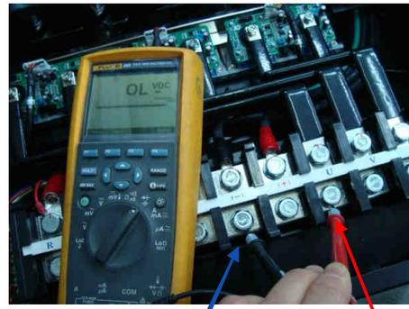
Щуп COM прибора к клемме (-)      Щуп  $\Omega$  прибора к клемме U
