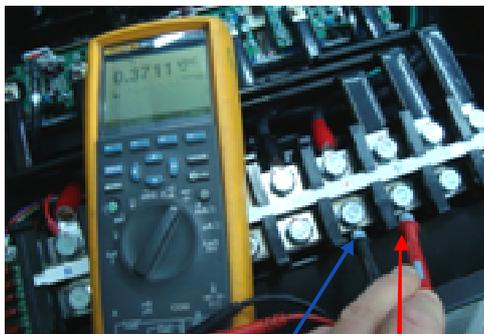
Щуп COM прибора к клемме (+)
