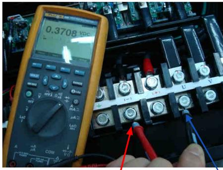
Щуп  $\Omega$  прибора к клемме (-)      Щуп COM прибора к клемме U
