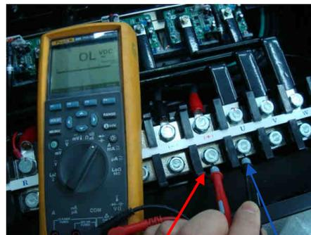
Щуп  $\Omega$  прибора к клемме (+)
