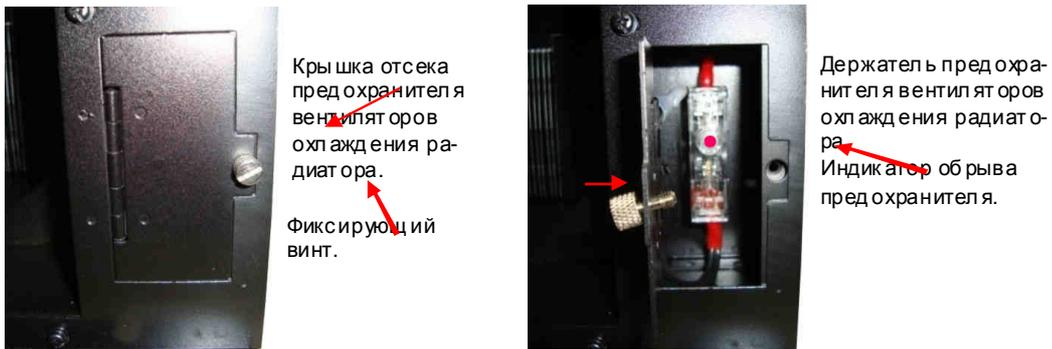
Рис. 4.26. Предохранитель цепи питания вентиляторов охлаждения радиатора
