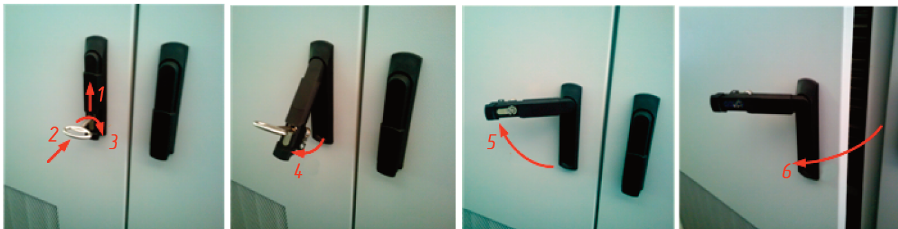
Рисунок 7 - Порядок открытия двери шкафа КН24
