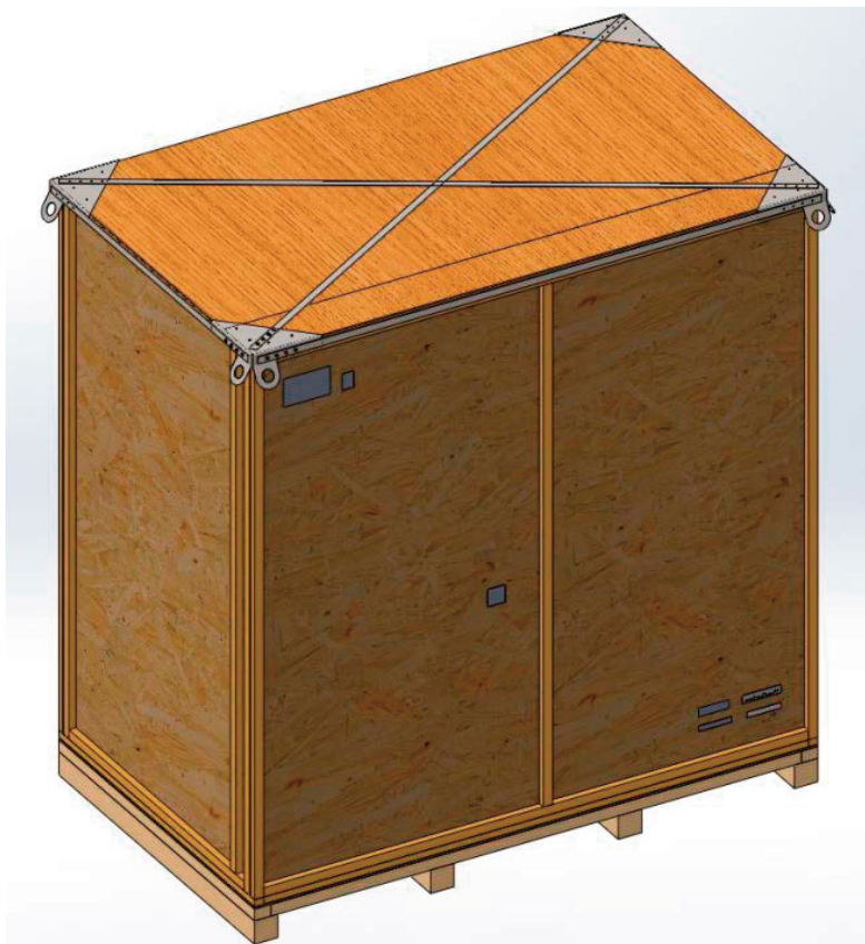
Рисунок 22 - Упаковка со строповочным узлом (в комплекте не поставляется)
